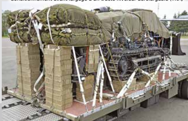
Conditionnement avant largage d'un tracto niveleur aéroneur (TNA)
